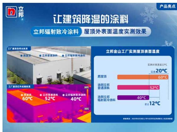
该产品可广泛应用于混凝土或金属基面的建筑，尤其适用于高温高能耗场景，能为无法安装制冷设备的建筑有效降温，并帮助在智能化转型后对温控有着更高要求的建筑物降低能耗。
